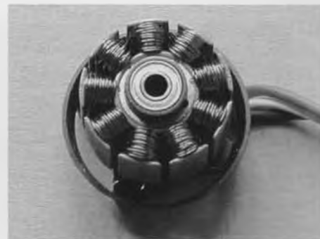
Σχήμα 2. Ένας υψηλός συντελεστής πλήρωσης είναι αρκετά σημαντικός: στην περίπτωση που παρουσιάζεται εδώ υπάρχει χώρος για περαιτέρω βελτίωση!
