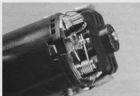
Σχήμα 5. Το σύστημα ψηκτρών ενός DC κινητήρα με μηχανική εναλλαγή είναι αρκετά πολύπλοκο, παρουσιάζει σημαντικές απώλειες και τριβές.
