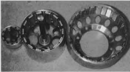
Σχήμα 12. Η απόσταση μεταξύ των μαγνητών σε μια μηχανή πολλαπλών πόλων (στη προκείμενη περίπτωση με εξωτερικό ρότορα) δεν θα πρέπει να είναι και τόσο μικρή. Στα δεξιά βλέπουμε έναν ρότορα δέκα πόλων όπου ένας πόλος σχηματίζεται από κάθε μια ομάδα τριών ρυθμιζόμενων μαγνητικών λωρίδων.
