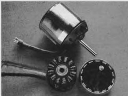
Σχήμα 14. Ένας σύγχρονος κινητήρας με εξωτερικό ρότορα σχεδιασμένος κατάλληλα για χρήση σε μοντελισμό.
