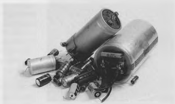
Σχήμα 3. Οι ηλεκτρολυτικοί πυκνωτές αποτελούν ένα σημαντικό πρόβλημα. Οι παλαιότεροι τύποι πυκνωτών είναι δυνατόν να περιέχουν επιβλαβή υλικά όπως είναι τα πολυχλωριούχα διφαινύλια (PCB).
