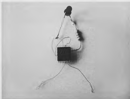
Σχ. 2. Ένα κύκλωμα αναλαμπών LED. Το μόνο που χρειάζεται είναι ένας R8C/13 που 'τρέχει' με το εσωτερικό σήμα χρονισμού του.
