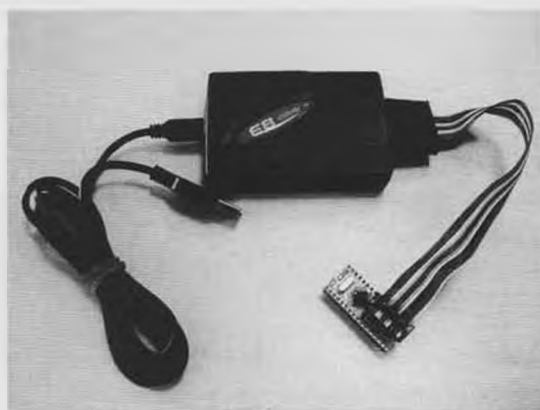
Σχ. 3. Το κύκλωμα αποσφαλμάτωσης E8 της Glyh επιτρέπει την παρακολούθηση ενός προγράμματος σε πραγματικό χρόνο.
